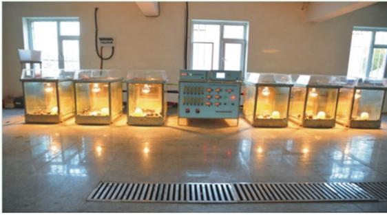
图 1 禽用 6 室并联开放回流式呼吸测热装置
